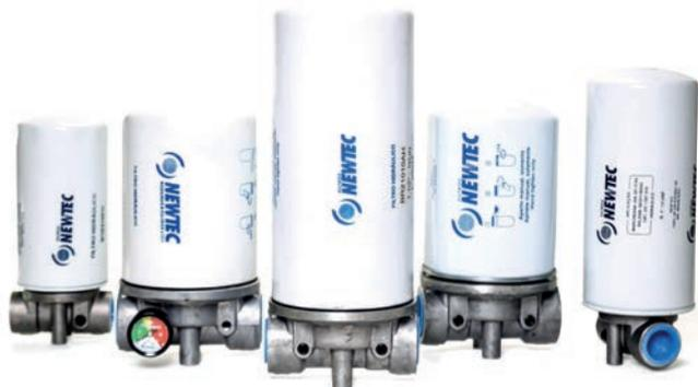
Os filtros de retorno encontram-se na extremidade da linha de retorno e são concebidos para a montagem próxima ou sobre o reservatório. Isso significa que o fluido que vem do sistema, é filtrado quando escoar para o reservatório. Assim, todas as partículas de contaminação que entram no sistema (por exemplo, pela haste do cilindro ou vazamentos) ou são geradas pelo mesmo, ou são retiradas do fluido antes de ingressar no reservatório.
